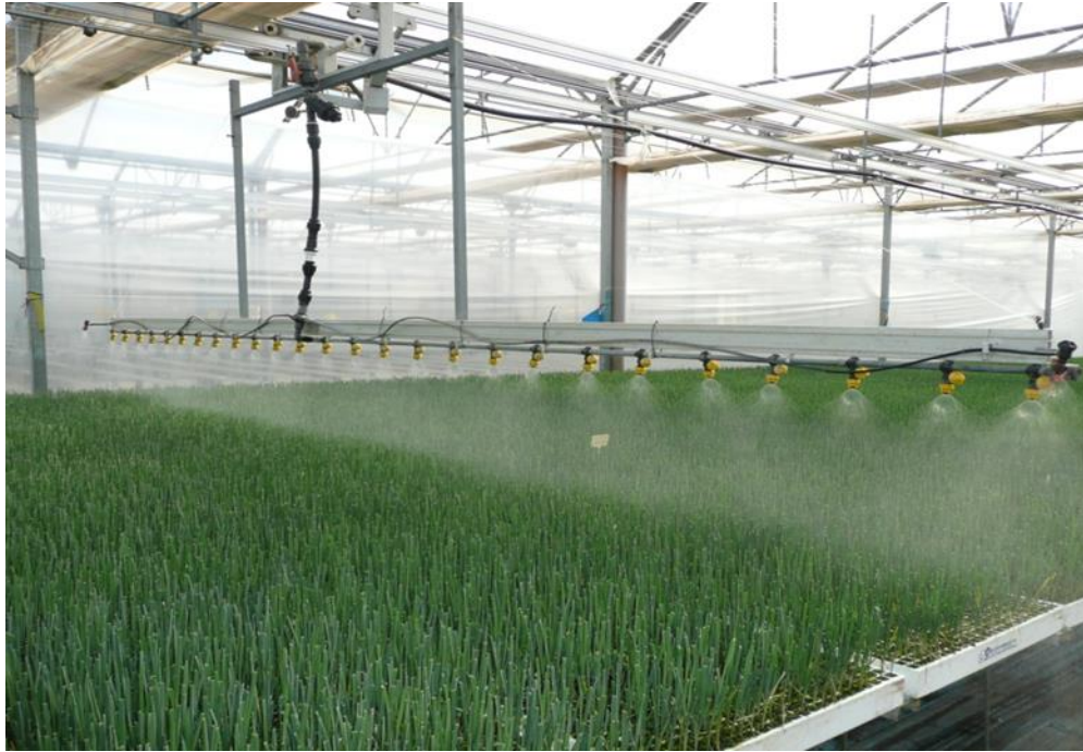
Barra horizontal de desplazamiento automático con posibilidad de regulación en altura
