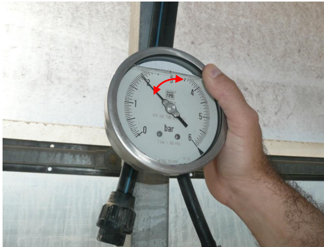
Inestabilidad en la presión indicada por el manómetro
