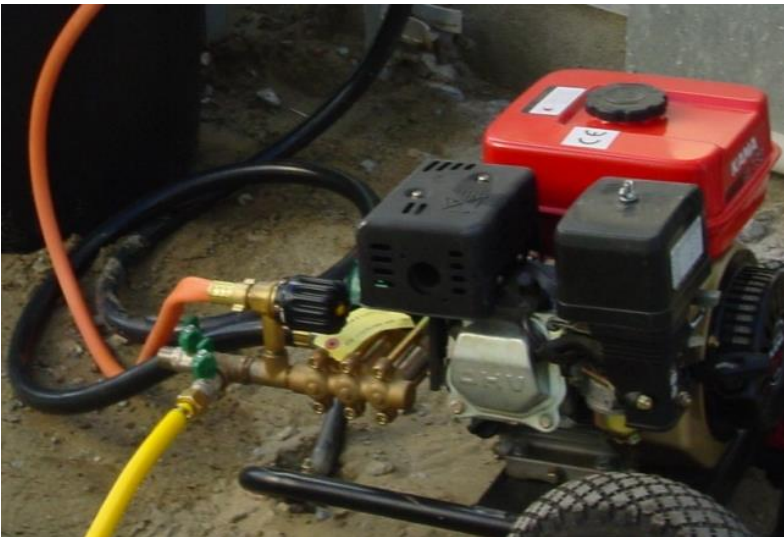
Tubería doblada en un equipo semi-móvil, que impide el paso correcto de líquido
