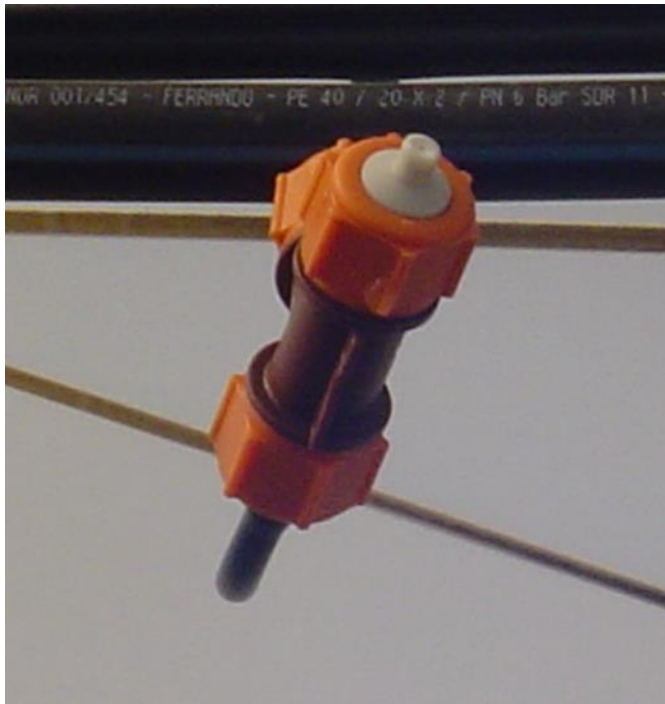
Boquilla donde se observa que no hay goteo transcurridos 5 segundos
