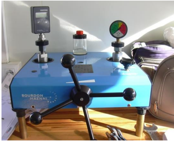
Bancos de ensayo de manómetros con manómetro de referencia digital
