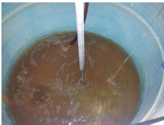
Sistema de agitación mixto pero insuficiente. El líquido no recircula visiblemente
