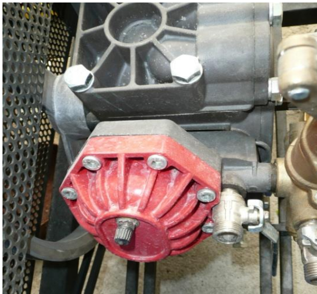
Calderín de la bomba en buen estado
