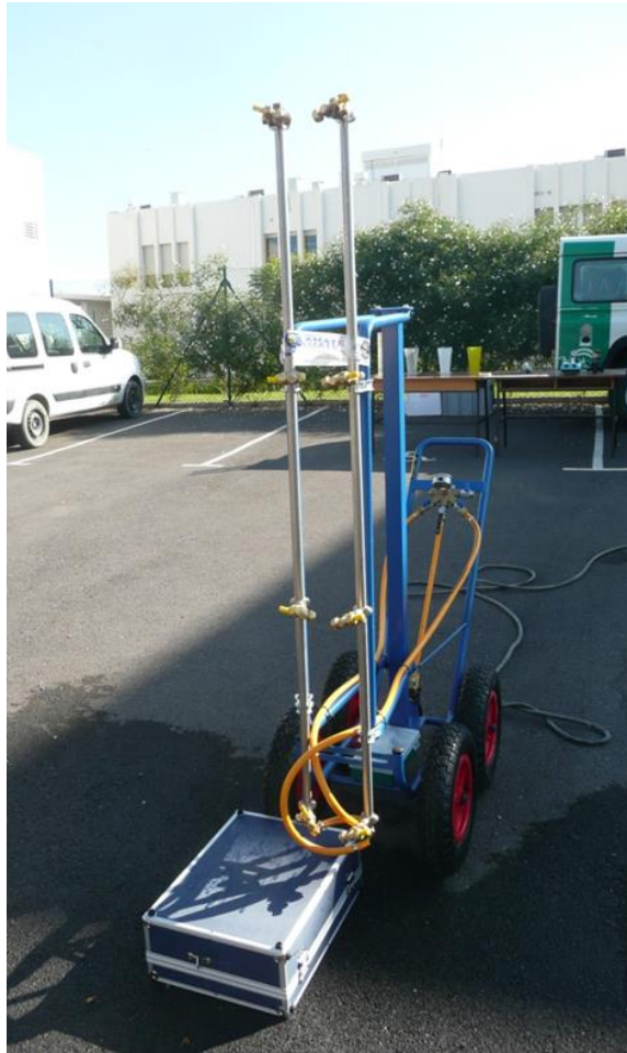
Carro de barras verticales con boquillas orientables y situadas a la misma distancia
