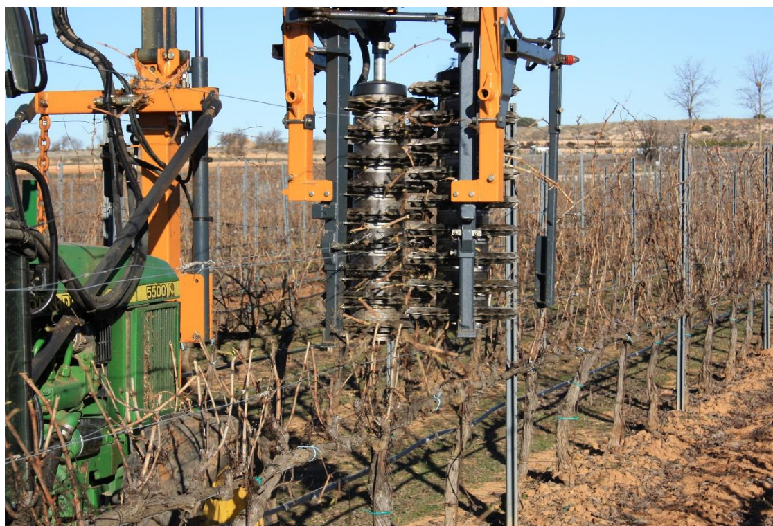
Figura 1.1.1. Realización de pre poda mecanizada en una espaldera con poda corta en cordón unilateral. El Socorro (Colmenar de Oreja, Madrid).
