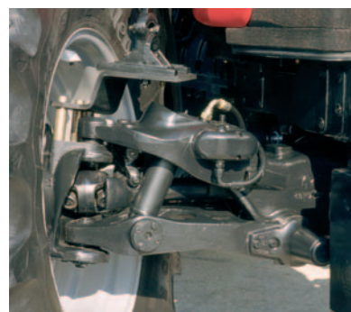
Detalle de la suspensión del eje delantero.
